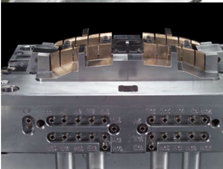
Kernkompetenzen: Besondere Stärken offenbart Rebhan u. a. bei Extrusionsblas- sowie Spritzblas- und Spritz-Streckblasformen. Bei den Spritzgießformen sind es Mehrkomponenten- und Hybrid-SGF, Gasinnendruck- und Multikavitätentechnik.
