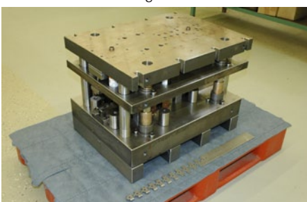
Folgeverbundwerkzeug aus dem Hause Ernst Keller mit dem zugehörigen Folge-verbundstreifen für einen Schlosshalter.
