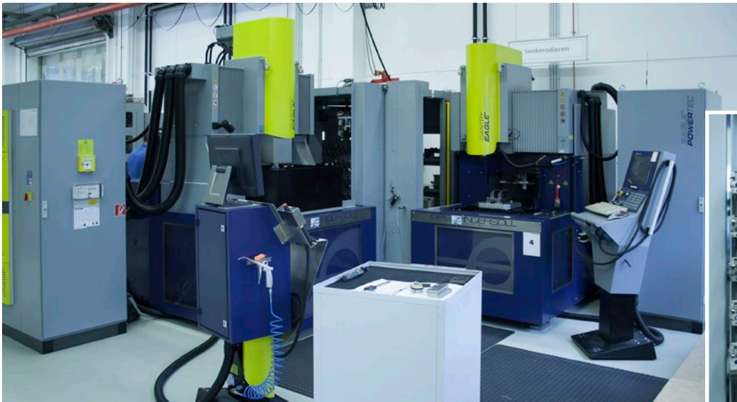
Über eine zentrale Robotik werden zwei Erodiermaschinen von OPS-Ingersoll aus einem Magazin mit Elektroden versorgt. Zusammen mit dem Palettenwechsler erlaubt diese Ausstattung über einen längeren Zeitraum den mannlosen Betrieb in der Senkerosion. Das angeschlossene Elektroden-Magazin ist dazu in der Regel prall gefüllt (rechts).
