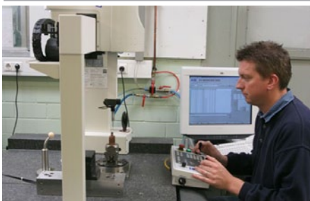
Thorsten Gössling überprüft an einem Zeiss-Messsystems die Genauigkeit des Erodierprozesses. Die Messdaten werden anschließend an den Agie AV-Manager übergeben.
