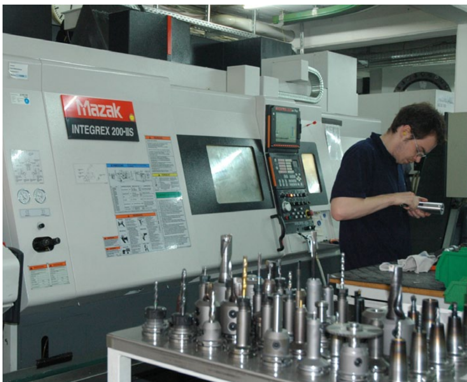
Die Mazak Integrex 200-IIIIS verfügt über eine Stangenzuführung, Hauptspindel, Gegenspindel und Frässpindel. Das Magazin fasst bis zu 80 Werkzeuge.
