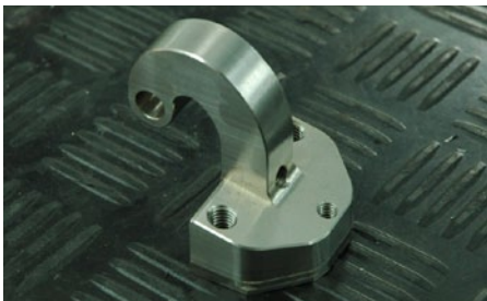
Werkstücke können in einer Aufspannung komplett bearbeitet werden. Einige Werkstücke sind dabei reine Frästeile. Zeitersparnis im Vergleich zur Fertigung auf der Fräsmaschine: bis zu 75%.
