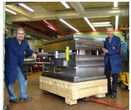
Auch große Formen sind kein Problem: Spritzgießform bei der Auslieferung, Gesamtgewicht 9 Tonnen.
