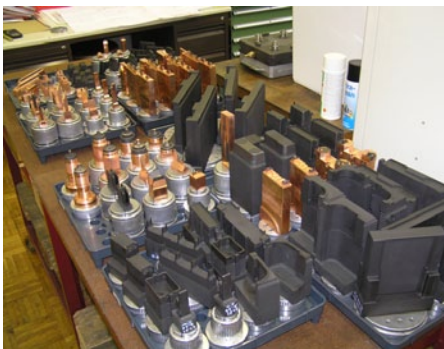
Ob in Grafit oder in Kupfer, ob für diffizile Einzelheiten oder für komplette Kavitäten: Elektroden kommen bei Büchler in fast allen Größen zum Einsatz. Bei den Haltern verwendet man System 3R.
