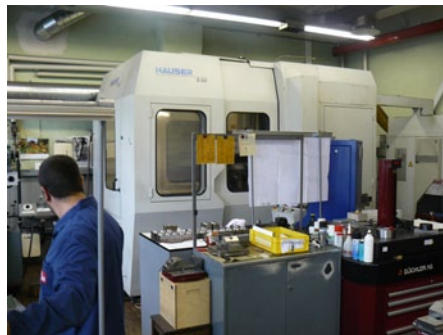
Die Koordinatenschleifmaschine Hauser S 50 HI-Cut mit Fanuc-Steuerung ist über die Cimatron-Lösung angebunden.
