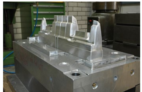
Ein großer Anteil der Prototypenwerkzeuge wird aus hochfesten Aluminium-Legierungen gefertigt. Im Bild die Werkzeugzeugunterhälfte der links abgebildeten Konstruktion.
